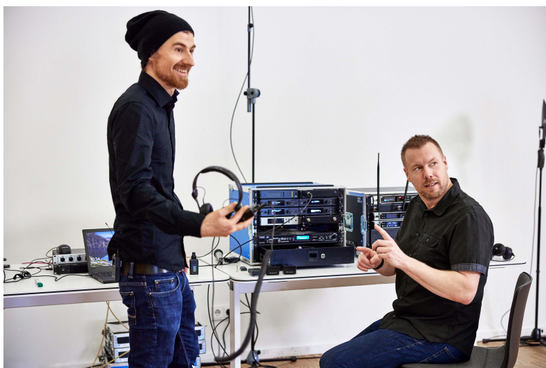
Marco i Jonas ze sprzętem RF. Wąskopasmowe nadajniki IEM oraz odbiorniki mikrofonowe w środku i z prawej strony; prototyp WMAS w obudowie rack 19" 1U, po lewej stronie
