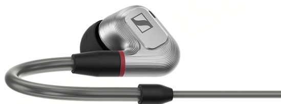
Obudowy elementów dousznych IE 900 są wyfrezowane z jednego bloku aluminium, aby stworzyć unikalny system trójkomorowego absorbera (T3CA)
